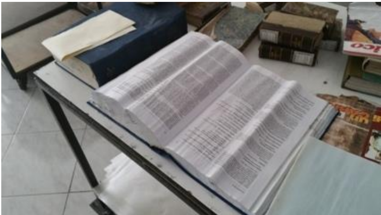
Figura 33. I danni da bagnamento su uno dei volumi. L'eccessivo livello di umidità nell'ambiente ha provocato la deformazione delle pagine. Immagine fornita da Prodoc.
