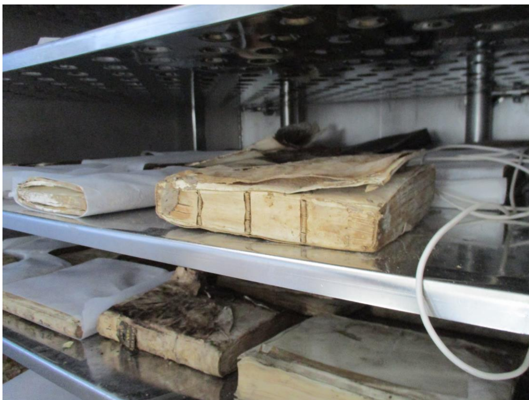
Figura 30. Alcuni dei volumi della biblioteca all'interno del liofilizzatore presso il laboratorio di Gallarate di Prodoc. Questa immagine è stata realizzata dal personale di Prodoc durante l'attività pilota di liofilizzazione di 1000 chilogrammi di materiale danneggiato. Immagine fornita da Prodoc.
