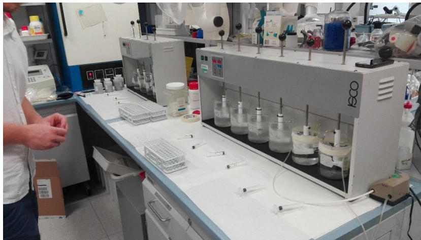
Figura 7 Jar test. Fase di allestimento iniziale con preparazione di Becker da 1 L con soluzioni contenenti mFe (20g/L).
