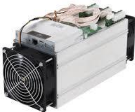
Figura 3.6 Hardware ASIC: Antiminer S9 della Bitmain.
