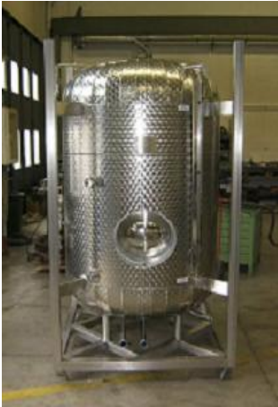
Figura 19: Esempio di autoclave per il metodo Charmat (foto: https://www.vinook.it/vino-rosso/vino-rosso-lombardia/lambrusco-otello.asp )
