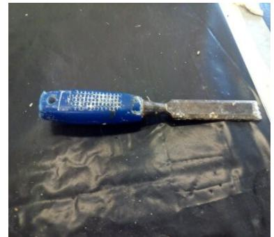
esagonale che presenta spigoli arrotondati. Per lavorare la pietra o il marmo si usano scalpelli simili a quelli impiegati nella lavorazione del legno e dei metalli. Per le lamiere si usa lo scalpello pneumatico, il quale viene azionato ad aria compressa. Un altro tipo di scalpello è quello a corona che permette di lavorare rocce molto dure.
