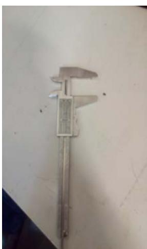
Il calibro è uno strumento per la misura della lunghezza inventato nel 1631 da Pierre Vernier<sup>31</sup>. Si presta a misurare la lunghezza di un oggetto con alta precisione, la distanza tra due facce piane di una concavità e la profondità di un solco. In scultura viene, in particolare, usato il calibro a compasso costituito da due bracci metallici sagomati e aventi il fulcro in un'estremità.
