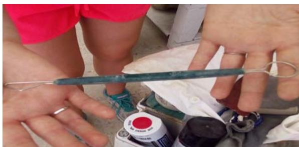
Le mirette sono anche chiamate occhielli o chiavette. Sono formate da un corpo centrale in legno e da due parti in ferro, ognuna delle quale è fissata ad un'estremità del supporto ligneo. Le mirette vengono usate nel processo di modellazione dell'argilla. In base al tipo di filo di ferro che le compone hanno impieghi differenti: le
