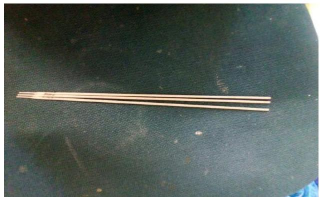
durante il processo di saldatura l'elettrodo si consuma e il metallo di cui è formato va a legarsi al metallo da saldare.
