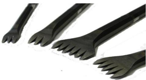
Utensile in acciaio usato per lavorare la pietra e molto simile allo scalpello, ma con più denti che possono essere appuntiti o piatti. Viene usato in una fase intermedia della lavorazione, dopo l'impiego della subbia e prima di quello dello scalpello.
