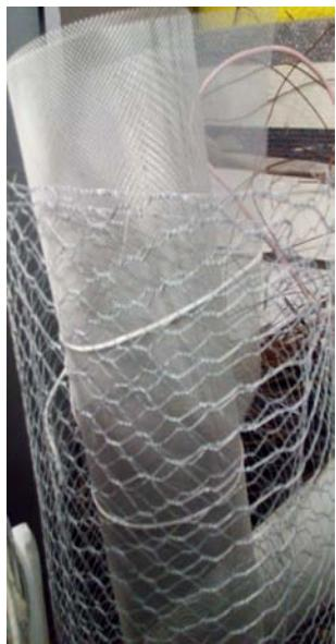
Al giorno d'oggi, molti scultori usano nuovi materiali per la realizzazione delle loro opere, tra queste c'è la rete metallica, costituita da fili metallici elettrosaldati. La rete metallica viene prodotta industrialmente e può essere realizzata con vari materiali: ferro, ferro zincato, alluminio, rame, bronzo, ottone, acciaio e filo di ferro. Può essere modellata facilmente anche con il solo uso delle mani e, in quanto rete, permette di vedere anche la parte interna dell'opera.
