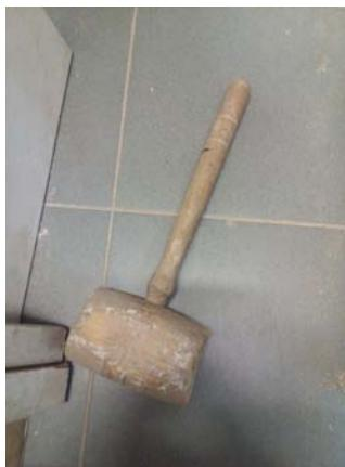
Si tratta di un attrezzo usato sia in ambito scultoreo sia in falegnameria. Viene percosso sulla sgorbia o, più in generale, sullo scalpello. È solitamente in legno e si compone di due parti: la testa, ossia una parte più grossa e pesante, di forma cilindrica o quadrata che raggiunge i 60-80 mm di diametro e dal manico. In alcuni casi la testa può anche essere realizzata in ferro.
