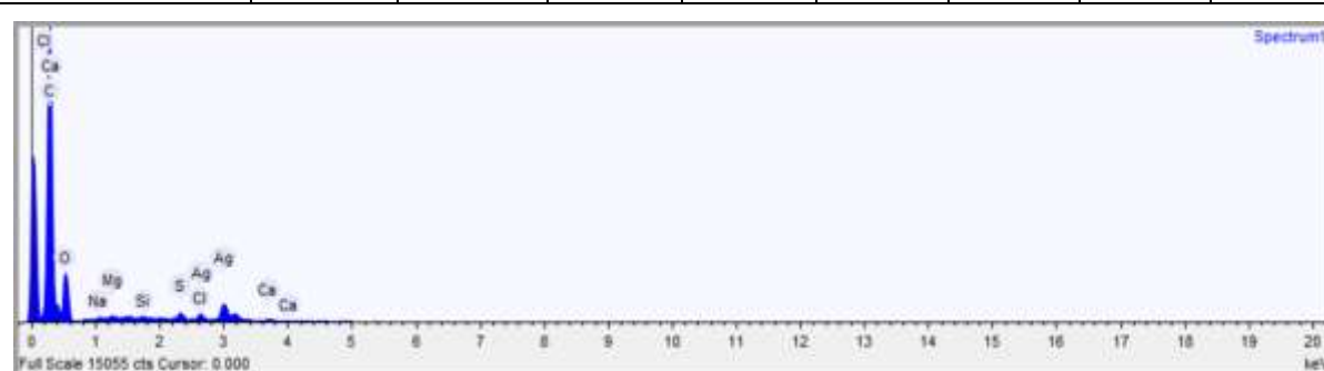
Figura 86 Spettro EDX del punto N17-COLLA dopo il trattamento con il plasma atmosferico
