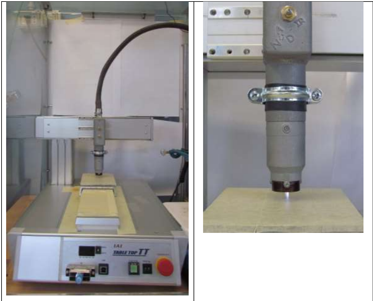
Figura 38 Foto della torcia progettata da Nadir s.r.l e dell'assetto utilizzato durante la sperimentazione
