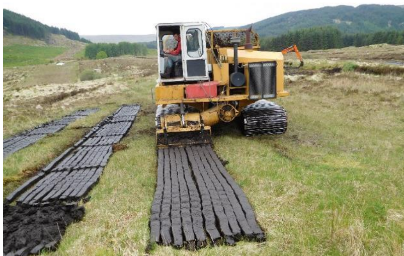
Figura 66 Macchinario che crea i filari di torba nella zona di bog presso le Ox Mountains. Foto: G. Cavanni.
