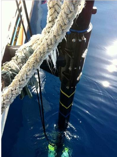
Figura 7.3 – MB Reson Seabat 8125H montato a palo, lateralmente alla murata del Dallaporta.
