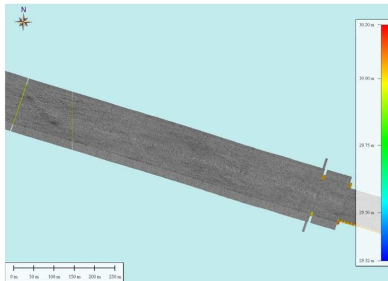
Figura 7.12- Elaborazione del dato Sidescan-like del Reson SeaBat 8125H. Geobar a 50cm di risoluzione (UTM33-WGS84).
