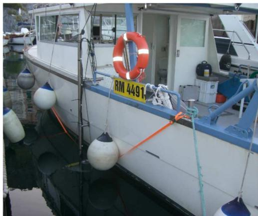
Figura 4. 1 – Il Reson SeaBat 8125 montato a palo lateralmente all'imbarcazione.
