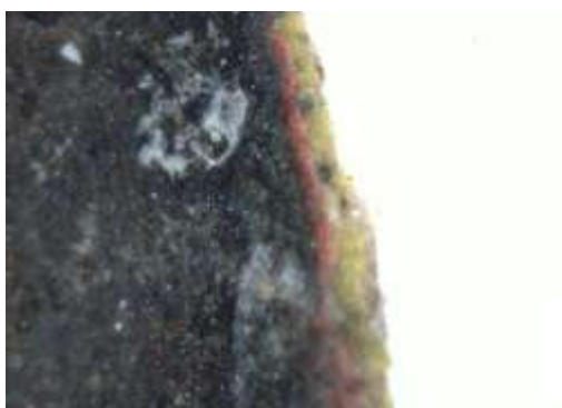
Foto 55. Immagine al Dino della superficie della pittura rossa annerita. Luce visibile. 250X.
