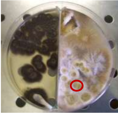
Foto 28. Foto della capsula petri a dieci giorni dall'inoculazione del biodeteriogene presente nella stesura pittorica blu e punto di prelievo per vetrino.
