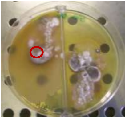
Foto 43. Foto della capsula petri a dieci giorni dall'immersione di un campione rosso nel terreno di coltura e punto di prelievo per vetrino.
