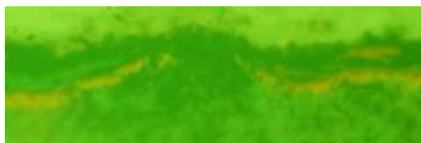
Foto 63. Immagine al MO della stratigrafia di un campione di pittura rossa annerita. Luce UV. 100 X.
