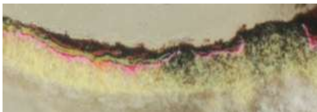
Foto 61. Immagine al MO della stratigrafia di un campione di pittura rossa annerita. Luce visibile. 40 X.
