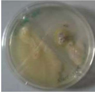
Foto 22. Foto della capsula petri a quattro giorni dall'immersione del campione di pittura rossa nel terreno di coltura.
