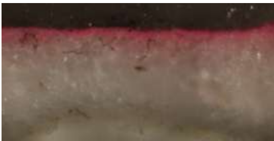
Foto 59. Immagine al MO della stratigrafia di un campione di pittura rossa in cui si vedono le ife che attraversano l'intera sezione del campione. Luce visibile. 100X.
